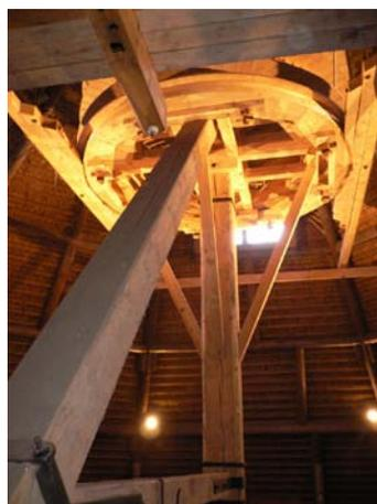
Im Inneren des Göpels: Bremsgestänge und Seiltrommel
